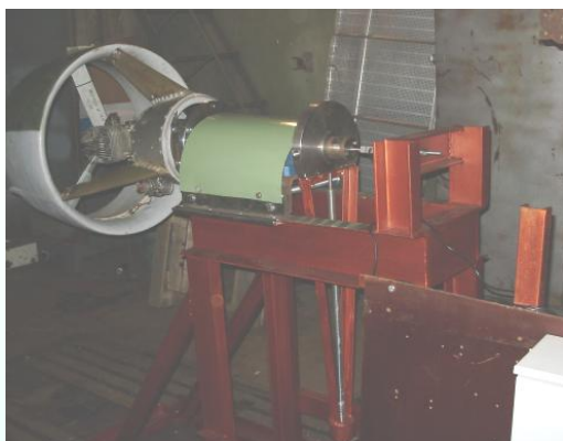
Мобильный винтовой стенд с возможностью установки в ТБК (стенд У-335)
