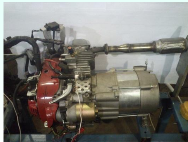
Исследовательский одноцилиндровый модуль двигатель на стенде У-338
